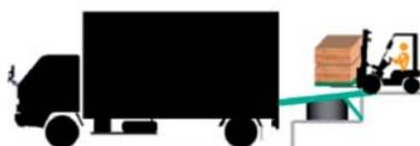
O equipamento foi desenvolvido para utilização em docas de carga e descarga, servindo de ponte entre a doca de concreto e o piso da carroceria do veículo
